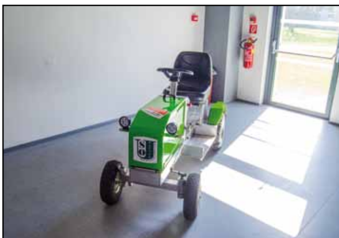
Ekologický elektrický zahradní malotraktor - realizovaný projekt studenta průmyslovky na Technické olympiádě v Českých Budějovicích
