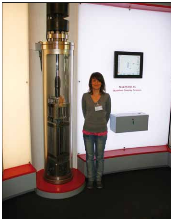
Model palivového souboru se zasunutým regulačním orgánem a jeho pohonem
