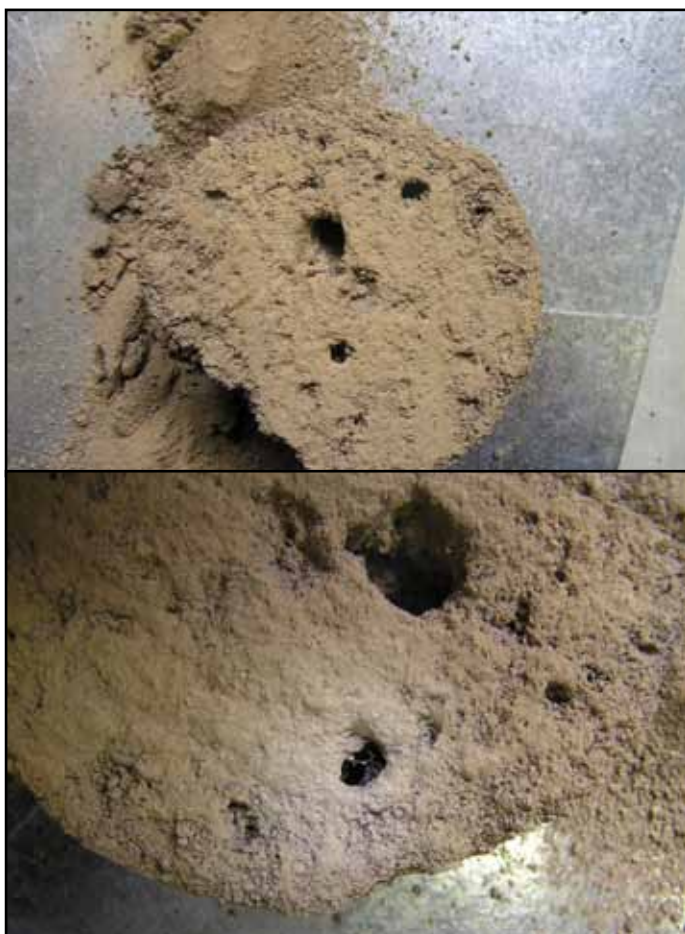
Značně porušený původně kompaktní vzorek písčité zeminy ovlivněný prouděním vody. Kaverna velikosti vlašského ořechu. „Kompaktní eidam se stává sýrem ementálského typu!“
