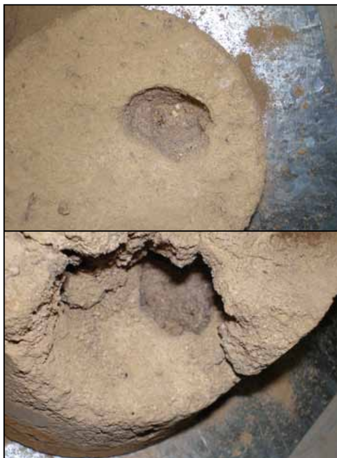
Značně porušený původně kompaktní vzorek písčité zeminy ovlivněný prouděním vody. Kaverna velikosti vlašského ořechu. „Kompaktní eidam se stává sýrem ementálského typu!“
