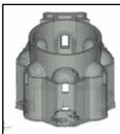
Obrázek 7. Šíření trhlin v kostele sv. Barbory ve Vížňově v důsledku dodatečného sedání
